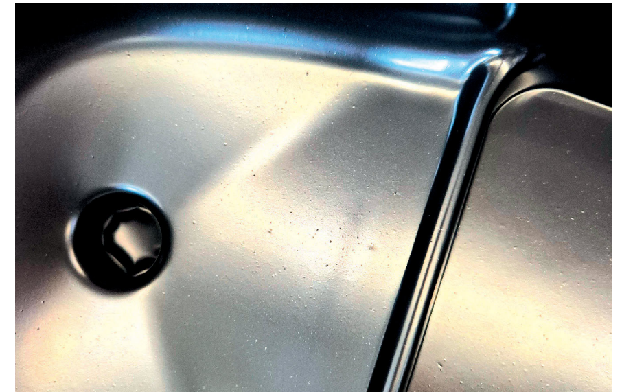
Bild 1. Hier sind typische Blasen- und Oberflächenfehler bei rezyklathaltigen Tiefziehteilen zu erkennen. © Formary
