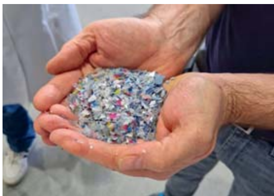
Recycelte Kunststoffflakes, die für das Tiefziehverfahren weiterverwendet werden.
